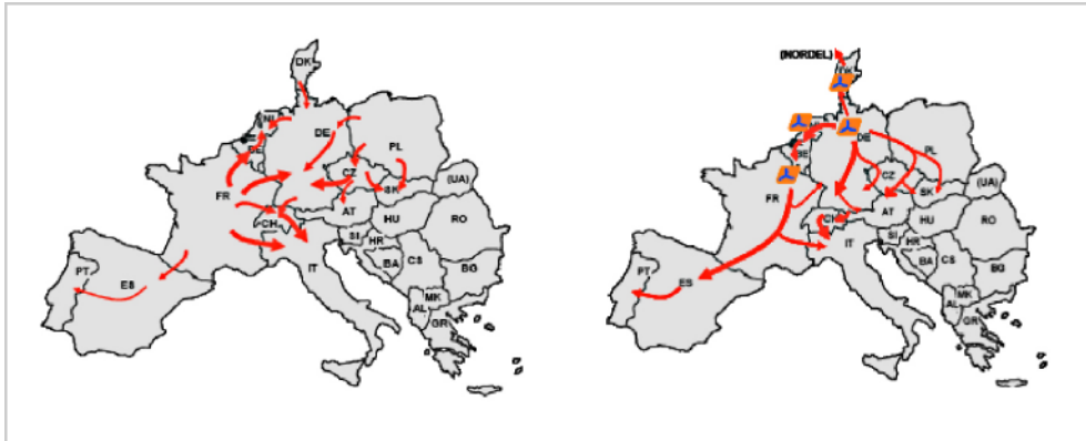
Figure 2.1: Comparaison 40 des flux électriques dans une situation de 2008 caractérisée par de faibles conditions de vent (schéma de gauche) et dans un scénario de forte intégration de production éolienne dans le Nord de la zone (schéma de droite).
